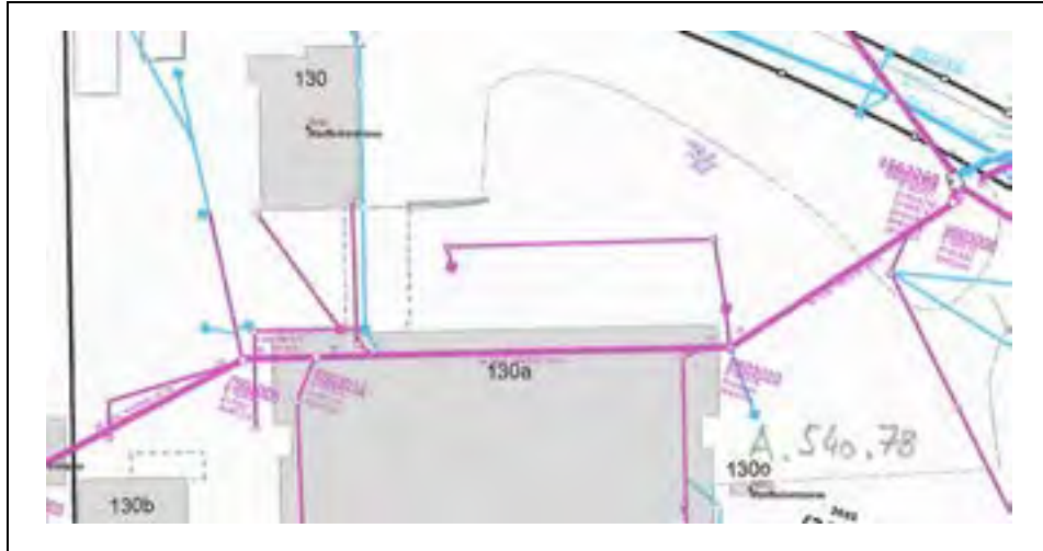
Abbildung 1; Vorhandener Mischwasserkanal unter dem Kopfbau des Shedhalle
